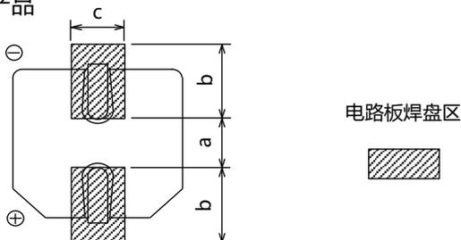
(推荐电路板焊盘尺寸)
