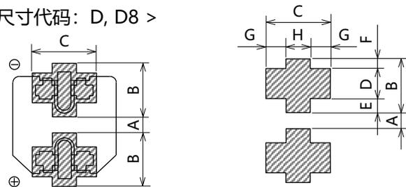
(推荐电路板焊盘尺寸)
